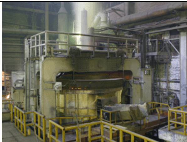
Рис. 2. Дуговая печь постоянного тока нового поколения ДППТУ-25, применяемая для плавки чугуна и стали.
